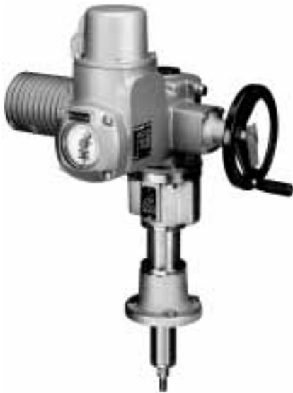
Прямоходный механизм LE с электроприводом SA/ SAR усилие на штоке от 4 кН до 217 кН величина хода до 500 мм скорость перемещения от 20 до 360 мм/мин
