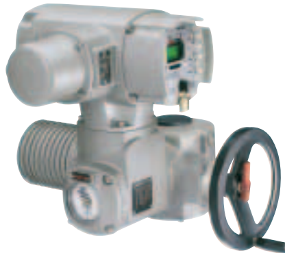
Электроприводы SA/ SAR с узлом управления AUMATIC крутящий момент от 10 до 1 000 Нм частота вращения от 4 до 180 мин -1
